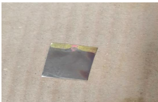
照片8 0.01mg/ml 石墨烯镀液所镀的镍层
