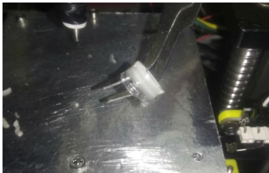
照片4 紫外光固化3D打印的管状结构
