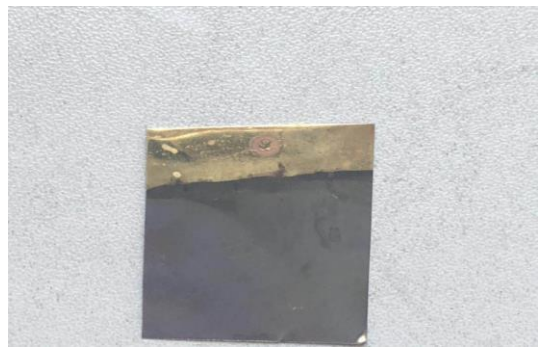
照片9 0.03mg/ml 石墨烯镀液所镀的镍层
