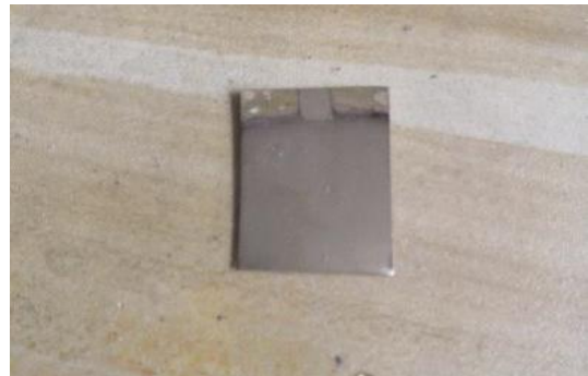
照片 4 0.03mg/ml 石墨烯镀液的镀层
