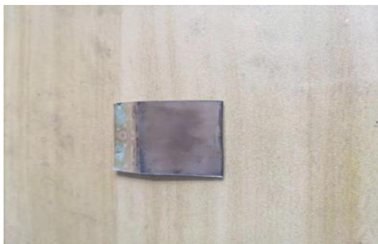
照片2 0.03mg/ml 石墨烯镀液镀层正面
