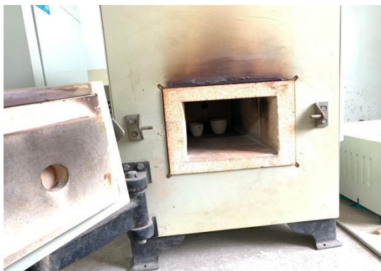
照片8 水滑石样品在500°C下进行焙烧
